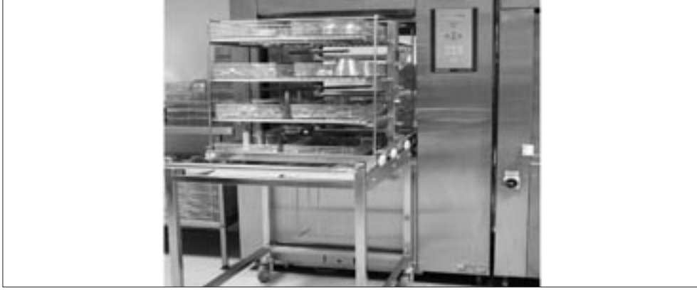
Resim 3. Yıkayıcı-dezenfektör ve cam kapısı. Bu kapı nedeniyle içi görülebilir.
