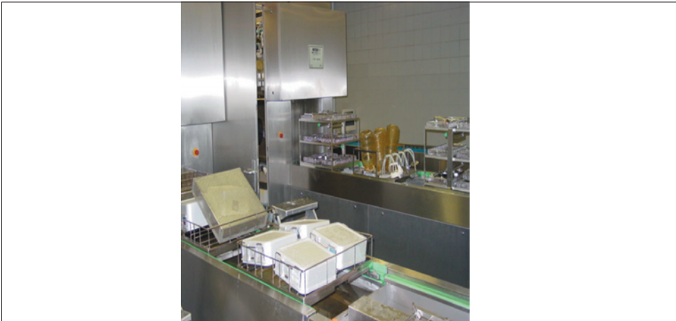
Resim 6. Tünel yıkayıcı dezenfektörler.
