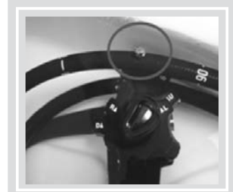
Resim 21. Kaçak testi ile arıza tespiti.
